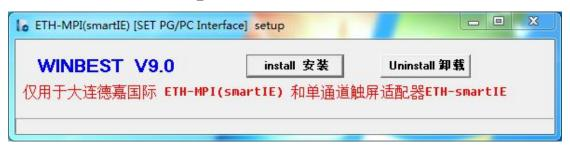
然后选 [install 安装],完成后,你就能在西门子的 set the PG/PC interface 中找到 ETH-MPI(auto)、ETH-MPI、ETH-DP 三个驱动选项,插 MPI 口的时候应选择 ETH-MPI,插 DP 口的时候应选择 ETH-DP,ETH-auto则可以自动识别 MPI/DP 口和波特率,所以建议使用 ETH-auto 驱动。
