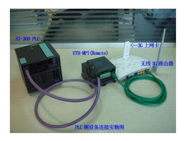
PLC 侧的 ETH-MPI(Remote)实物图及设置:
