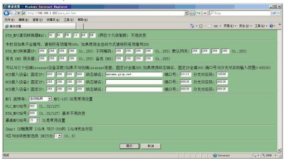
注意,3个RCD接入设备中,没使用的固定IP一定要填写全填写为255,如果填写为000会造成设备不停的重新启动,无法正常运行,如图
