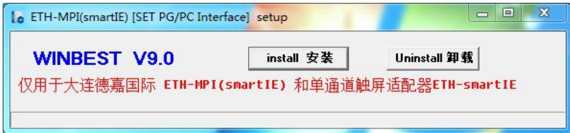
然后选 [install 安装], 完成后, 你就能在西门子的 set the PG/PC interface 中找到 ETH-MPI(auto)、ETH-MPI、ETH-DP 三个驱动选项, 插 MPI 口的时候应选择 ETH-MPI, 插 DP 口的时候应选择 ETH-DP, ETH-auto 则可以自动识别 MPI/DP 口和波特率, 所以建议使用 ETH-auto 驱动。
