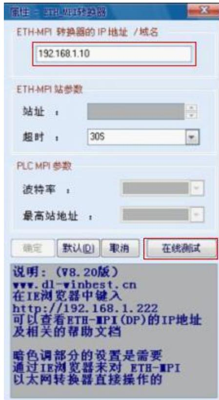
4. 可通过[在线测试]按钮测试填入的 IP 地址是否与 ETH-MPI 转换器完全一至。如果不能与 ETH-MPI (DP) 正常通讯，需在 IE 浏览器中键入 <http://192.168.1.222> 来查 ETH-MPI (DP) 转换器的 IP 地址，然后修改“设置 PG-PC 接口”中 ETH-MPI 的 IP 地址。
